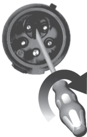
Fig. 17 Omkoppling av faser för 3-fasstyrenheter med fasvärdare
