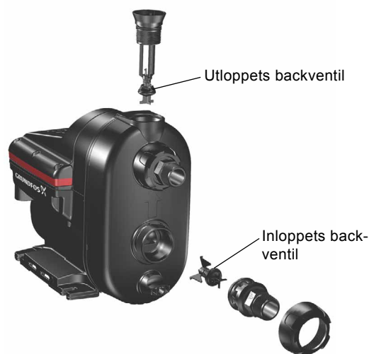
Fig. 20 Utlopps och inlopps backventiler
