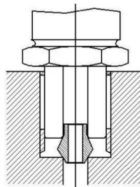
Dubbel konisk tätning för tryck  $\geq 1000$ bar
