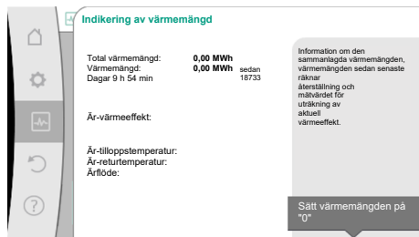
Fig. 93: Indikering av värmemängd
