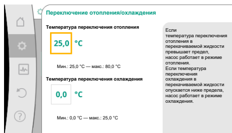
Fig. 51: Переключение отопления/охлаждения_Температуры переключения
