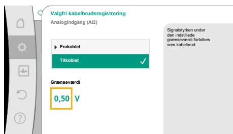
Fig. 78: Grænseværdi for kabelbrud
