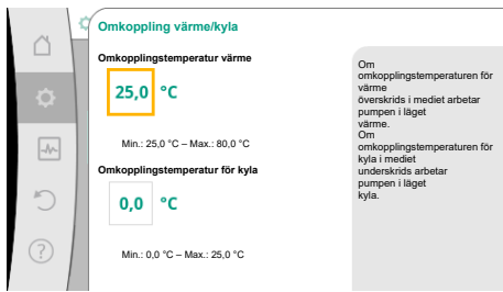
Fig. 51: Omkoppling värme/ kyla_ Omkopplingstemperaturer
