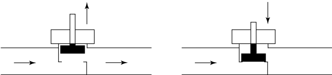
Bild 3 Links: Das Ventil ist geöffnet, wenn die Ventilspindel ausgefahren ist. Rechts: Das Ventil ist geschlossen, wenn die Ventilspindel in das Ventil hineingeschoben ist.
