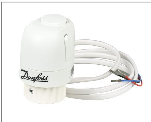
ABNM är en 0-10 V proportionell termomotor. Matningsspänningen är 24V AC och styrspänningen är 0-10 V DC. Motorns aktiva reglerområde föreligger när styrspänningen är mellan 2 och 10 V DC. Termomotorn omvandlar styrspänningen till en proportionell motorvandring.
