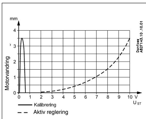
Styrspänningen på 0-10 V omvandlas till en lyfthöjd på 0-3,5 mm i termomotorn.
