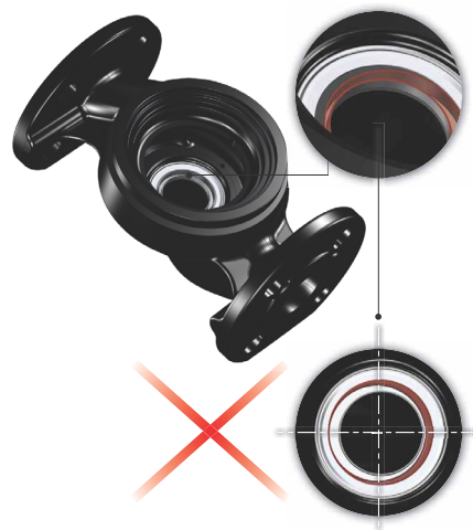
Fig. 13 Felaktigt centrerat tätningssystem
