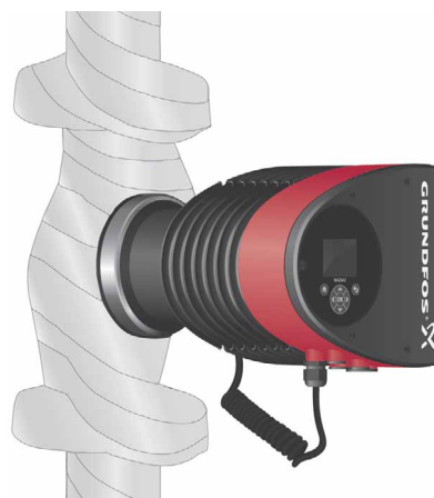
Fig. 18 Isolering av pumphus och rörrät
