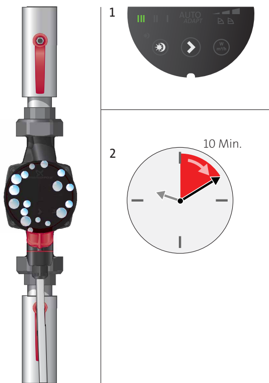
Fig. 24 Avluftning av pump
