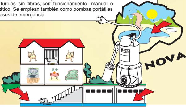
**SE - Nova:** Manuella eller automatiska dränkbara elpumpar som är lämpliga för pumpning av grumligt vatten utan fibrer. Kan även användas som bärbara pumpar vid nödsituationer.
