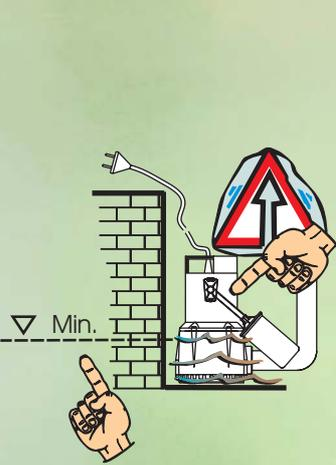
**IT -** L'elettropompa dev'essere installata in posizione verticale e adeguatamente immersa nell'acqua.
