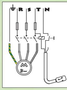
**IT** - L'elettropompa trifase comandata da un interruttore a galleggiante, deve essere alimentata tramite un contactore.
