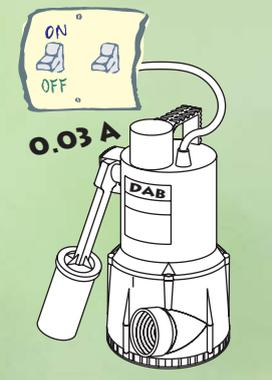
**IT - Nova:** elettropompe sommergibili idonee per pompare acque torbide senza fibre, con funzionamento manuale o automatico. Applicabili anche come pompe portatili per casi di emergenza.
