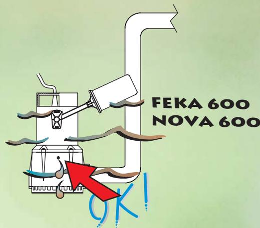
IT - Su Nova e Feka 600 è presente un foro di sfogo anticavitazione. Sono normali con pompa in funzione delle piccole fuoriuscite d'acqua.
