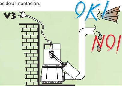
**SE -** Kontrollera trefasmotorens rotationsriktning. Korrekt rotationsriktning ger en högre kapacitet. I motsatt fall ska du koppla elpumpen från elnätet och kasta om fasledarna.
