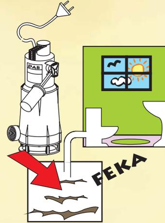
**SE - Feka:** Automatiska dränkbara elpumpar för fast installation som är lämpliga för pumpning av smutsigt vatten från avloppsbrunnar.
