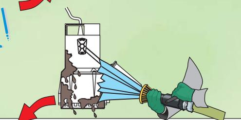
**IT** Se l'elettropompa è stata utilizzata con sostanze che tendono a depositarsi, risciacquarla, dopo l'uso, con un potente getto d'acqua.
