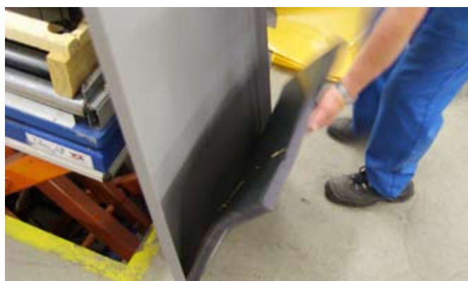
4. Montering av isolering på frontluckan.
