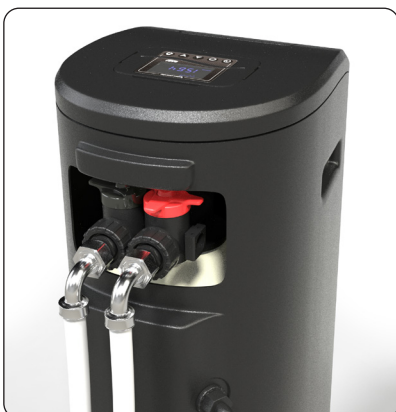
Bild 1. Anslutning av filtret sker lämpligast med tappvattengodkända flexibla slangar. Filtret är märkt med pilar och olika färger, svart för inkommande och röd för utgående vatten. tillse att filtret ansluts rätt.
