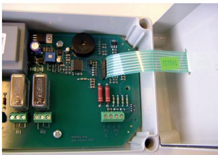
*Tillse att flatlisten från locket ansluts till kontakten på kretskortet korrekt.*
