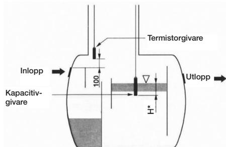
**H\*:** exakta monterings djupet finns angivet i ACO avskiljarens kapacitets tabell på produktbladet Oljeskikt alt fett-skikt vid tömningsnivå.
