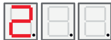
Die linke LED-Ziffer zeigt die Menüposition an.
