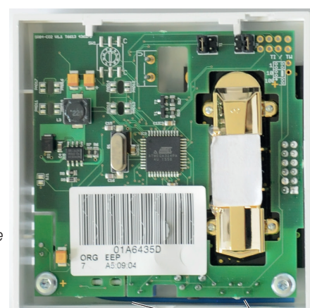
Knop "Leren" (onderaan): om de voeler te verbinden/pairen met de Gateway
