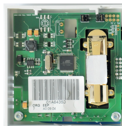
"Learn-knap" (på undersiden) til tilslutning/parring af føleren med gatewayen
