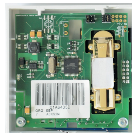
„Lernen“ Taste (darunter), um den Fühler mit dem Gateway anzuschließen/verbinden
