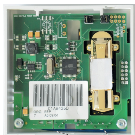
« Bouton d'apprentissage » (en dessous) pour connecter/appairer la sonde à la passerelle
