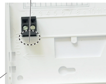
Bodemplaat: aansluiting, voedingsdraden
