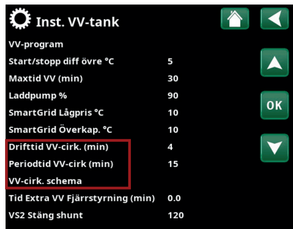
Del av meny "Avancerat/Inställningar/Varmvatten".
