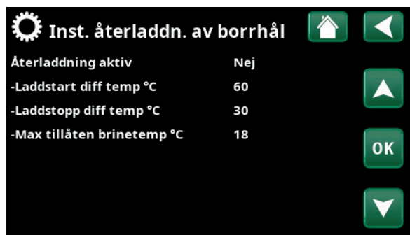
Meny "Avancerat/Inställningar/Solpaneler/Återladdning av borrhål"
