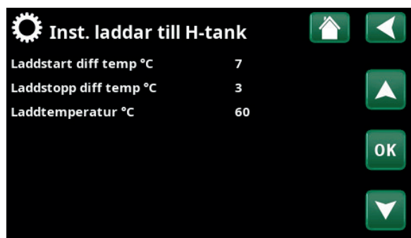
Meny "Avancerat/Inställningar/Solpaneler/Laddar till H-tank"
