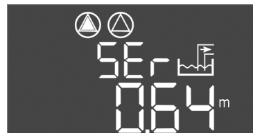
Fig 13.: Visning av serviceintervallindikering
