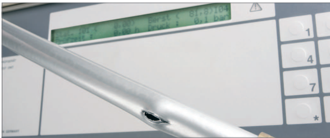
Fig. 3-1 Resultat av ett sprängtrycksprov med universalrör RAUTITAN flex
