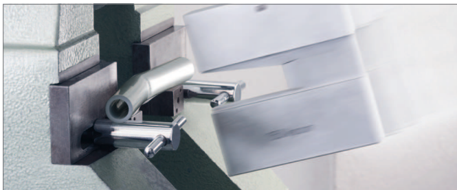
Fig. 3-2 Universalrör RAUTITAN flex i mätanordningen för slagseghet
