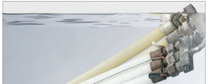
Fig. 3-4 Rör i ett långtidstest (under tryck i ett vattenbad)
