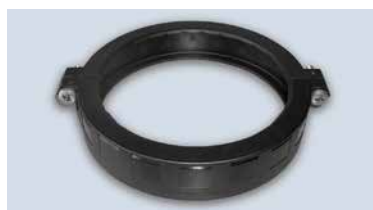
Från och med storleken DN/OD 90 är POLO-KAL NG ASV utrustat med 2 skruvar. Det högsta tillåtna åtdragningsmomentet är 7 Nm. (FIGUR 4)
