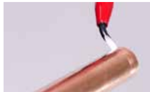
3. Använd ett gradverktyg för rörets insida
