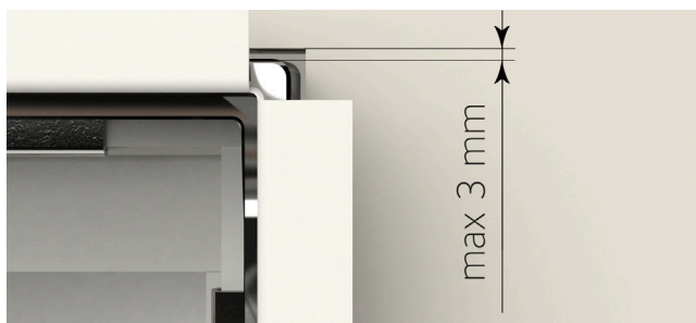
Max 3 mm avstånd mellan kant håltagning och ram
