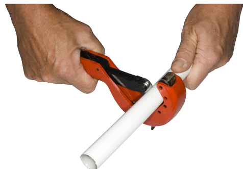
Kapning med röravskärare utrustad med skärtrissa för plaströr eller rörsax.
