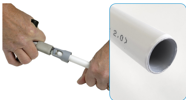
LK PAL Universalrör kalibreras och gradas med LK PressPex Kalibreringsverktyg F9.
