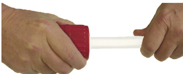
LK PE-X Universalrör gradas med rörfräs.
