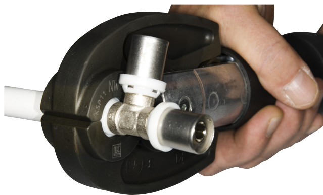
En öppning i framkant på backarna kan bero på att något främmande föremål hamnat mellan backarna och hindrat sammanpressningen.
