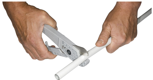
Kapning med rörsax.
