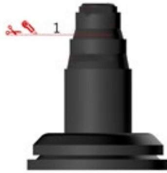
Kapning av rör genomföring 16mm.
