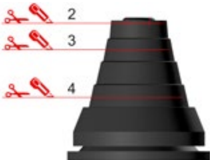
Kapning av rör genomföring 20-34 mm.
