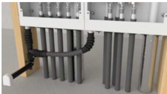
Sammankoppling av dränagerör.
