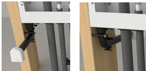
Principbild. Dränageböj direktansluten mot skåpets utloppsstos mynnar i samma rum som skåpets serviceöppning.
