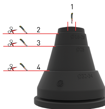
Kapning av LK Rör genomföring 20-25 LP.
