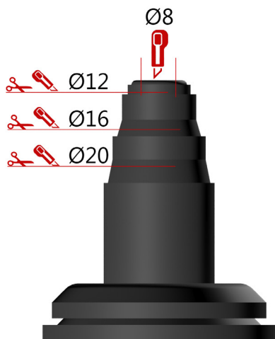
Kapning av rör genomföring för golvvärmerör.
