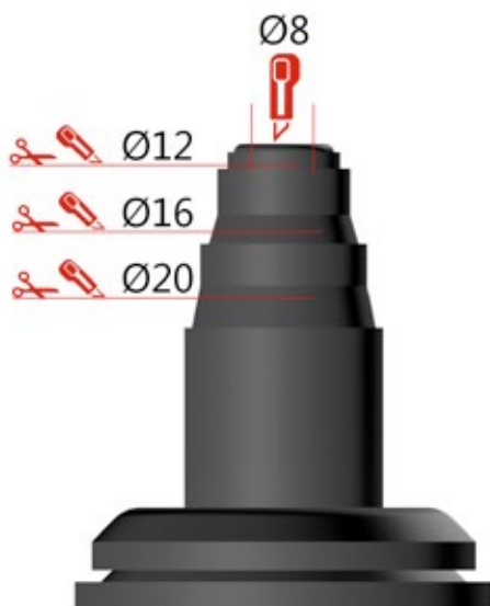
Kapning av rör genomföring.
