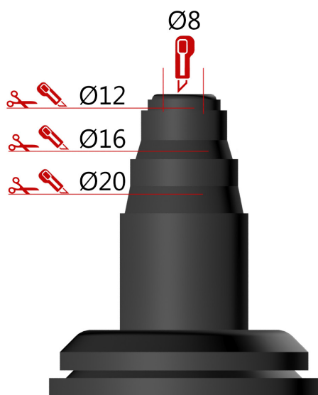
Kapning av rör genomföring.
