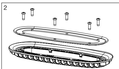
Skruva loss skruvarna i förhöjningsringen och ta bort klämringen. Lämna o-ringen i sitt sätt och säkerställ att den är på sin plats.
