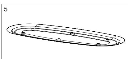
Skär med en kniv längs insidan av klämringen, så att inget tätskikt sticker ut. Kontrollera renskärningen genom att lyfta ur vattenåset ifrån utloppshuset.
