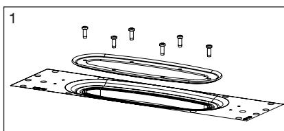
Skruva loss klämringen i utloppshuset. Spara skruvarna till klämringen. Lämna o-ringen i sitt sätt och säkerställ att den är på sin plats.
