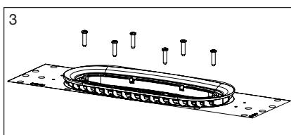
Skruva fast förhöjningsringen i utloppshuset med de sex skruvarna som medföljer.
