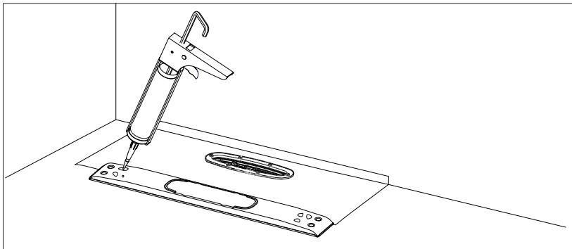
Punktlimma fast ramen på tätskiktet med montagelim alternativt fäst i klinkerfix. Du kan justera ramen i höjdled med hjälp av fix om så behövs.
