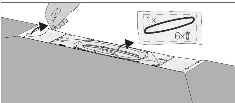
Ta bort skyddsfolien, lyft ur klämringen och plocka ut påsen som innehåller 1 st o-ring och 6 st skruvar.
