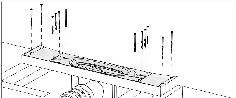
Montera brunnen direkt på träbjälklaget med tråskruvar och mot rå vägg.
