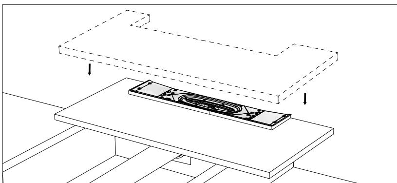
Lägg på en 22 mm spänplatta med öppning anpassad efter brunnens storlek.
