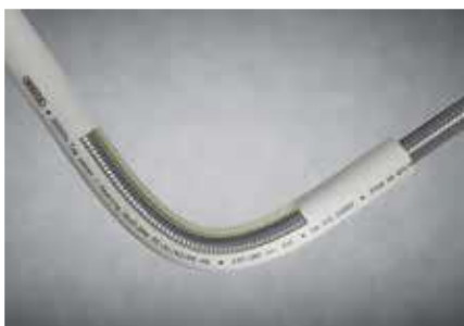
Bockning av röret med enbockningsfjäder.
