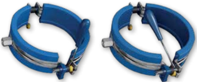
Ändra från justerbar till fixerad rörklammer: Ta bort det gula mellanlägget.
