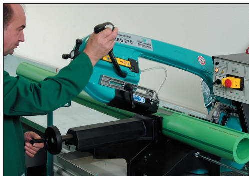
Kapa 160 mm röret till rätt längd före svetsningen
