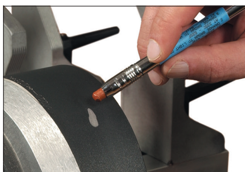
Temperaturkontroll med mätpenna
