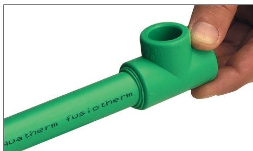
Sammanfoga, fixera och rikta rördelen
