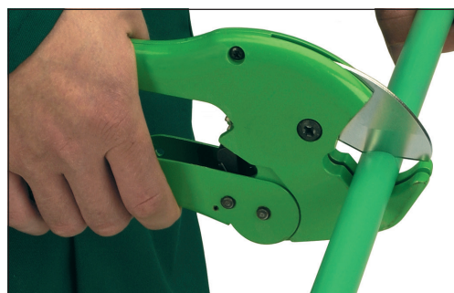
Avklippning av röret
