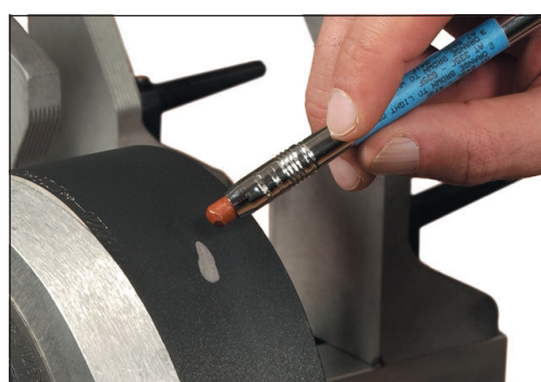
Temperaturkontroll med mätpenna
