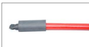
7.1 Trä på krympslang som är 30 mm (9 mm diameter). Se till att krympslangen ligger på ytterhöljet och krympslangen.
