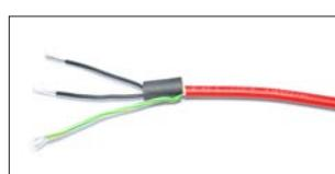
6.1 Trä på krympslang, 20 mm lång (9 mm diameter). Se till att krympslangen täcker isolerskiktet.
