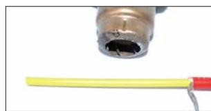
2. Värmt isolerskiktet runt om med en varmluftspistol så att det blir riktigt mjukt.
