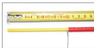
1.1 Skala av ytterhöljet genom att göra en anvisning i manteln och "knäck" kabeln.
