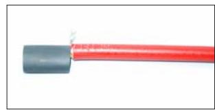
4.1 Trä på krympslang som är 20 mm (9 mm diameter). Se till att krympslangen är dikt an mot ytterhöljet.
