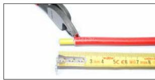
1. Skala av ytterhöljet 15 mm.
