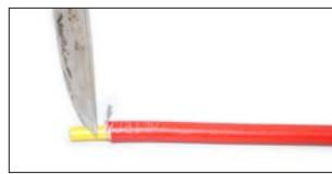
2. Skär bort isolerskiktet längs efter den ena ledaren med kniv.
