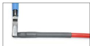
8. Trä på krympslang som är 100 mm (9 mm diameter). Som extra säkerhet kan krympslang 80 mm (12 mm diameter) krympas över änden.
