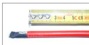
6. Kärhenna ulkovaippaa hiekkapaperilla noin 40 mm matkalta. Näin varmistetaan että liima kiinnitettävä kunnolla
