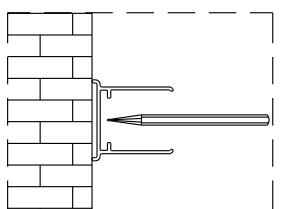
Sätt väggprofilen mot väggen och mätta in den. Markera skruvhålen på väggen.
