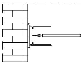
Sätt väggprofilen mot väggen och mätta in den. Markera skruvhålen på väggen.
