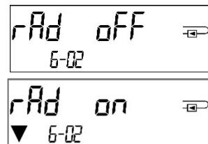
b) La fonction radio peut également être activée à l'aide du logiciel "Device Monitor". Ce logiciel peut être commandé séparément en option.
