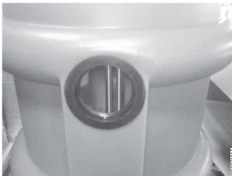
Figur 4: Inloppsrör diameter 100 mm
