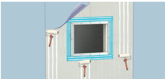
3. Applicera PCI Lastogum alt. PCI Pecilastic W-Lim tätmembran på övrig väggyta.
