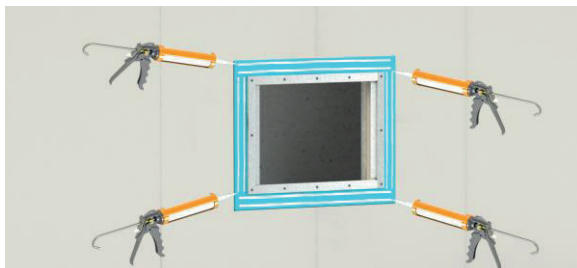
1. Applicera Kiilto Keraseal på ramens prefabricerade foliefläns.
