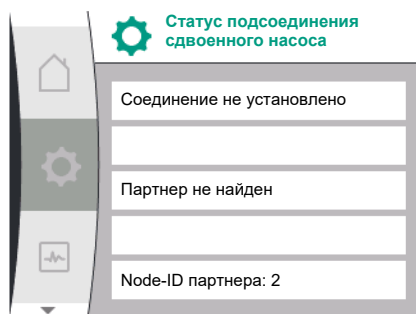
Fig. 52: Подключение сдвоенного насоса не выполнено
