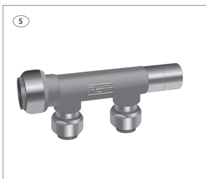
5. Sammankoppling av Roth Insticksfördelare. Fördelarrören sticks in i varandra till stopp. Rören kan sedan vridas till önskad vinkel så att kopplingsledningarna kan stickas in.
