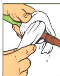
9. Linda en fuktig trasa om den exponerade plasten.
