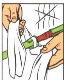
11. Ta bort den fuktiga trasan och för tillbaka plastisoleringen när fogen svalnat.
