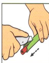
3. Skär upp plasten längs med röret.
