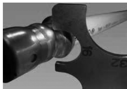
3. Placera verktyget över pressfördjupningen i presshylsan
