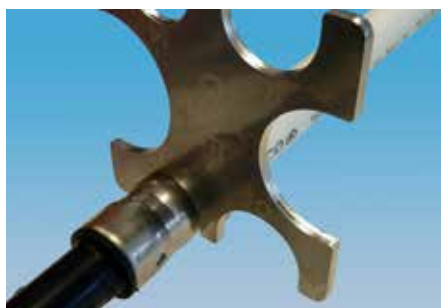
5. Roter verktyget 360° runt fördjupningen för att försäkra dig om att verktyget och hylsan passar perfekt ihop. Skulle du upptäcka att verktyget ej kan roteras innebär det att kopplingen är felaktigt pressad. Vi rekommenderar då att du gör om kopplingen helt och hållet. Dvs. kapar bort den felaktiga och ersätter med nya delar. Kontrollera alltid verktyget också.
