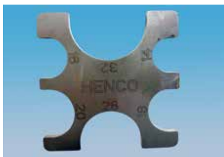
2. Leta rätt på motsvarande dimension på kontrollverktyget
