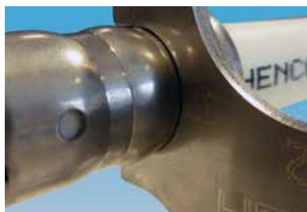
4. Kontrollera att urtaget i verktyget och pressfördjupningen i hylsan passar perfekt ihop
