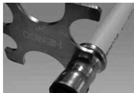
5. Roter verktyget 360° runt fördjupningen för att försäkra dig om att verktyget och hylsan passar perfekt ihop. Skulle du upptäcka att verktyget ej kan roteras innebär det att kopplingen är felaktigt pressad. Vi rekommenderar då att du gör om kopplingen helt och hållet. Dvs. kapar bort den felaktiga och ersätter med nya delar. Kontrollera alltid verktyget också.
