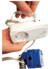
Vattensensorn kopplas in på vänstersida av enheten. (2 st sensorer kan anslutas)
