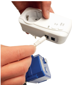
Inkoppling av ventilen görs på höger sida av enheten. (2 st ventiler kan anslutas)
