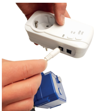
Bild 1. Inkoppling av ventilen görs på höger sida av centralenheten. (2 st ventiler kan anslutas.)
