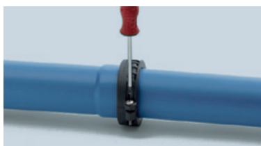
Sedan dras skruven åt. Åtdragningsmomentet är 5–7 Nm. Formdelsanslutningarna DN/OD 32–90 mm ska dras isär 5 mm innan POLO-KAL NG ASV monteras. (FIGUR 3)
