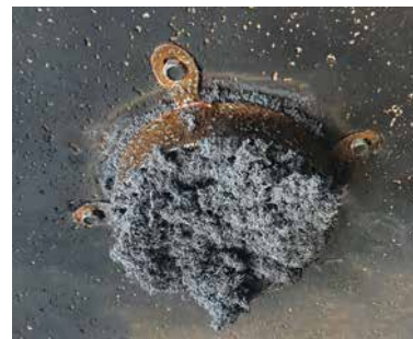
Brand- och hetgastät förslutning när brandskyddsmanschetten har utlöst
