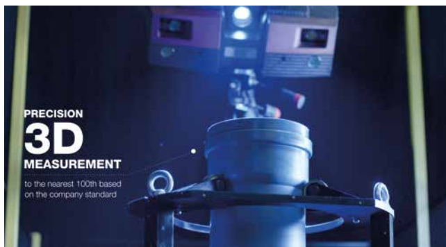
3D-mätning av POLO-KAL NG DN 200
