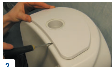
2 Stick in en mejsel och bänd upp locket (akta porslinskanterna och locket).
