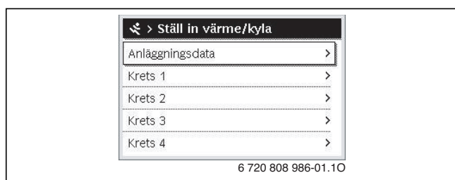
Bild 42 Menyn Inställningar för husvärme
