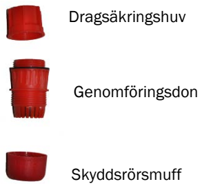
4b. Skåpsmuff 25/28mm. Lossa muffens dragsäkringshuv och för in genomföringsdonet genom skåpets hål i botten.
