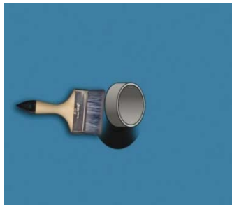
9 Prima över tätningsmanschett (rör på bild symboliserar tomrör 25 mm utan innerrör).
