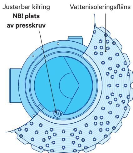
Montering av MERIKA® -vattenisoleringsfläns tillsammans med kvadratiskt lock på golvbrunn i betonggolv.
