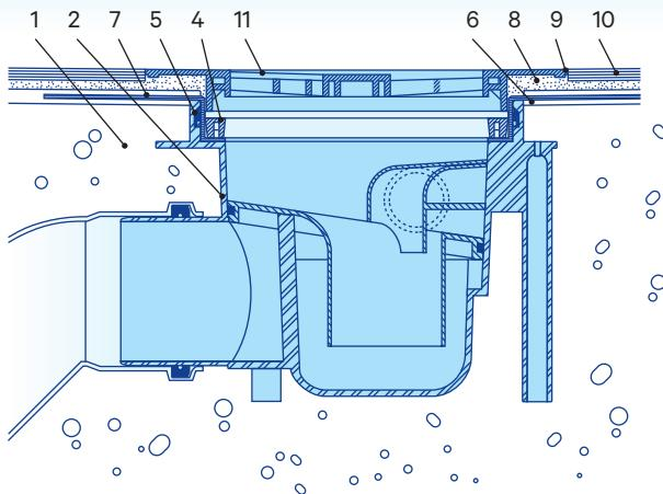
MERIKA®-vesieristyslaipan liittäminen neliökannen kanssa korotusrenkaalliseen lattiakaivoon lämpöeristetyssä betonilattiassa.
