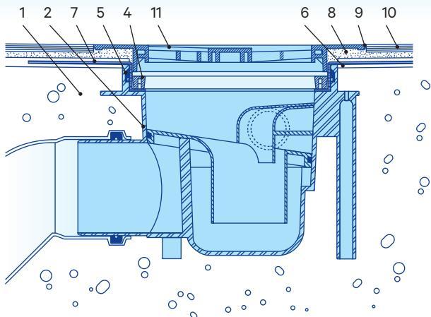
Montering av MERIKA® -vattenisoleringsfläns tillsammans med kvadratiskt lock på golvbrunn med förhöjningsring i värmeisolerat betonggolv
